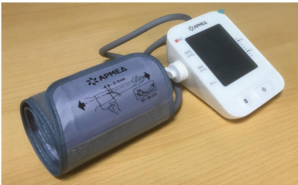
Рис. 1. Сфигмоманометр «Армед» YE660E с манжетой «360°»
